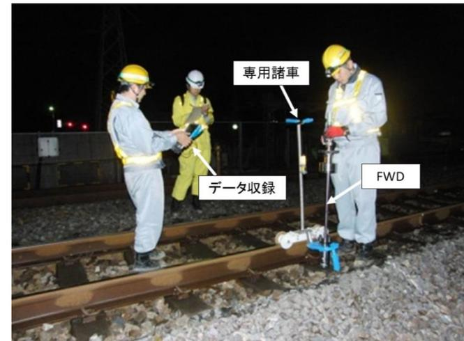
小型FWD を用いた軌道の支持剛性評価(伊藤ら, 2013,2014)
